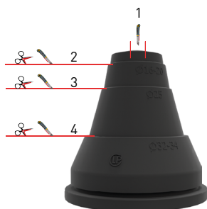
Kapning av rör genomföring.
