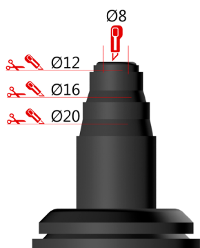
Kapning av rör genomföring.
